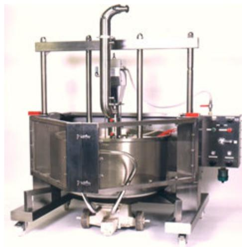
*Диаметр контейнеров от 300 мм до 1400 мм, мобильные или стационарные рамы, с защитными панелями или без.*
