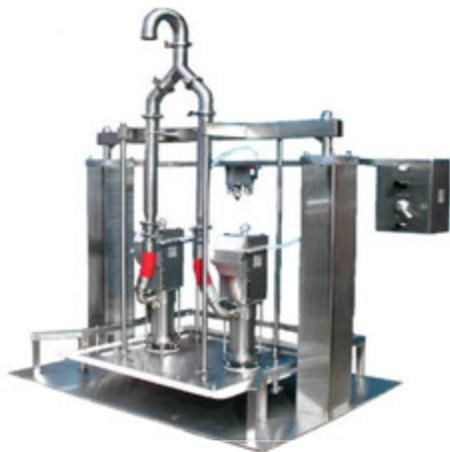
*Мы предлагаем индивидуальные решения по системам выкачки с использованием одного или двух насосов, для работы с цилиндрическими, квадратными или прямоугольными контейнерами.*
